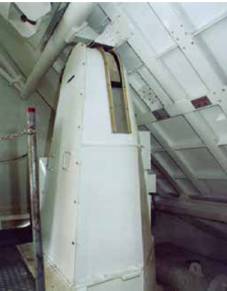
⑥ マスターコリメータ装置 主反射鏡中心軸の指向方向を精密に測定します。
