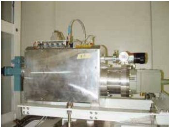
⑨ X帯低雑音増幅装置 ヘリウム冷却式の低雑音増幅装置です。
