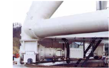
⑤ 方位角(Az)回転機構部 アンテナの方位角を制御する機構です。
